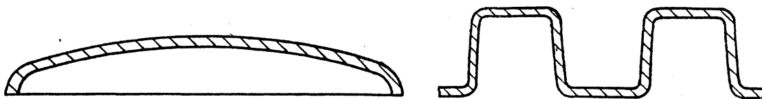
figuur 4.29 Alternatieve verstijvingsmogelijkheden.
